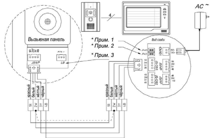
■ Примечание 1. Переключатель JP-VD предназначен для настройки импеданса видеосигнала. При использовании видеодомофонной системы с одним монитором переключатель JP-VD следует оставить на месте (она уже установлена). В системе с несколькими мониторами необходимо удалить переключатель JP-VD на всех мониторах, кроме последнего.
