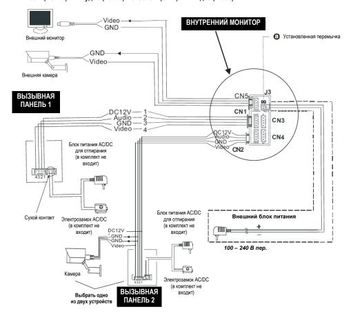
Если используются две вызывных панели (например, для парадного и черного входа), следует использовать соединители <u>CN1</u> и <u>CN2</u>. Два кабеля для подключения вызывных панелей показаны на схеме ниже. Обращаем внимание, что к двум вызывным панелям можно присоединить до 4-х мониторов.
