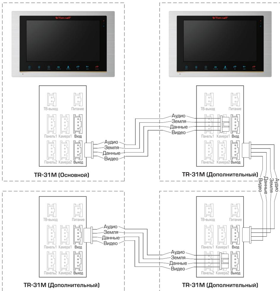
Вызывные панели, камеры, адаптеры питания, замки, изображенные на схемах, в комплектацию монитора не входят
