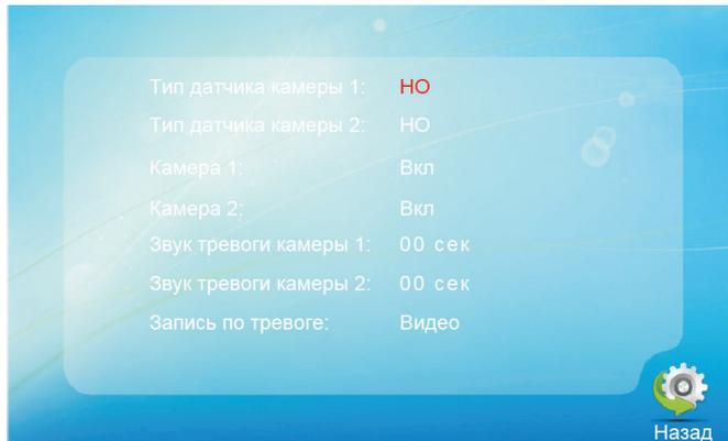
Программный детектор движения позволяет обнаруживать движение объектов без использования внешних датчиков, путем регистрации изменений, происходящих в области обзора используемой видеокамеры. Для реализации данной функции, питание камеры, используемой для детекции движения, должно быть постоянно включено. Это нужно для того, чтобы монитор имел доступ к изображению, поступающему с камеры и мог регистрировать его изменение.
