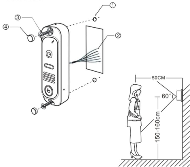
Дверной блок устанавливают на стену возле двери или на неподвижную створку двухстворчатой двери при условии отсутствия сильных вибраций створки.
