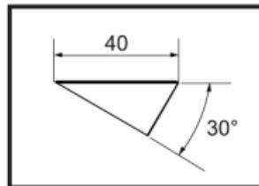
Модель DVC-411C, DVC-412C, DVC-414C комплектуется уголком, который используется для крепления изделия под углом  $30^\circ$  к плоскости установки. Уголок крепится к стене саморезами (Т1 4x40), а устройство устанавливается на него и закрепляется двумя винтами (М4x22).
