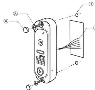
Дверной блок устанавливают на стену возле двери или на неподвижную створку двухстворчатой двери при условии отсутствия сильных вибраций створки.
